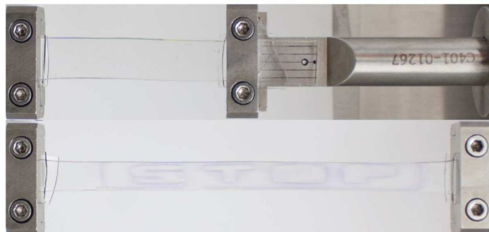
Figura 5.12: Signo “STOP” para un elastómero en su forma original y al ser deformado. Reimpreso con el permiso de [237] . Copyright (2018) American Chemical Society.
