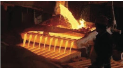
Imagen 2: Obtención de cobre mediante Pirometalurgia.
