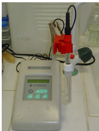
Imagen 1: Potenciómetro utilizado en laboratorio.
