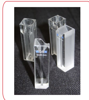
Imagen 4: Celdas cubetas que se emplean en el espectrofotómetro.
