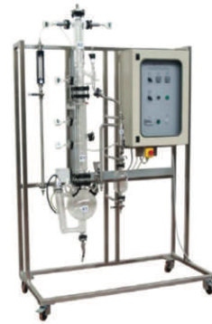
Imagen 3: Columna de destilación usada en Laboratorio de Ingeniería Química III.
