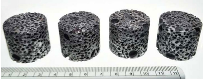
Figura 2. Espumas de aluminio obtenidas por el método de infiltración. 4
