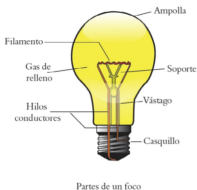
Figura 1. Lámpara incandescente: es la fuente de luz artificial más próxima a la luz del día.
