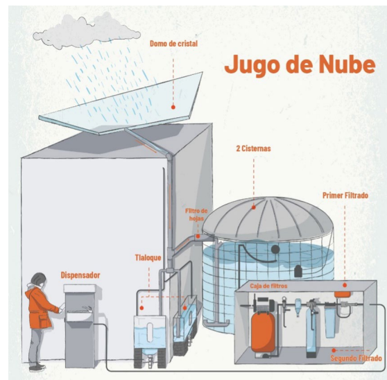
Figura 4. Sistema de captación de agua de lluvia, Jugo de Nube
